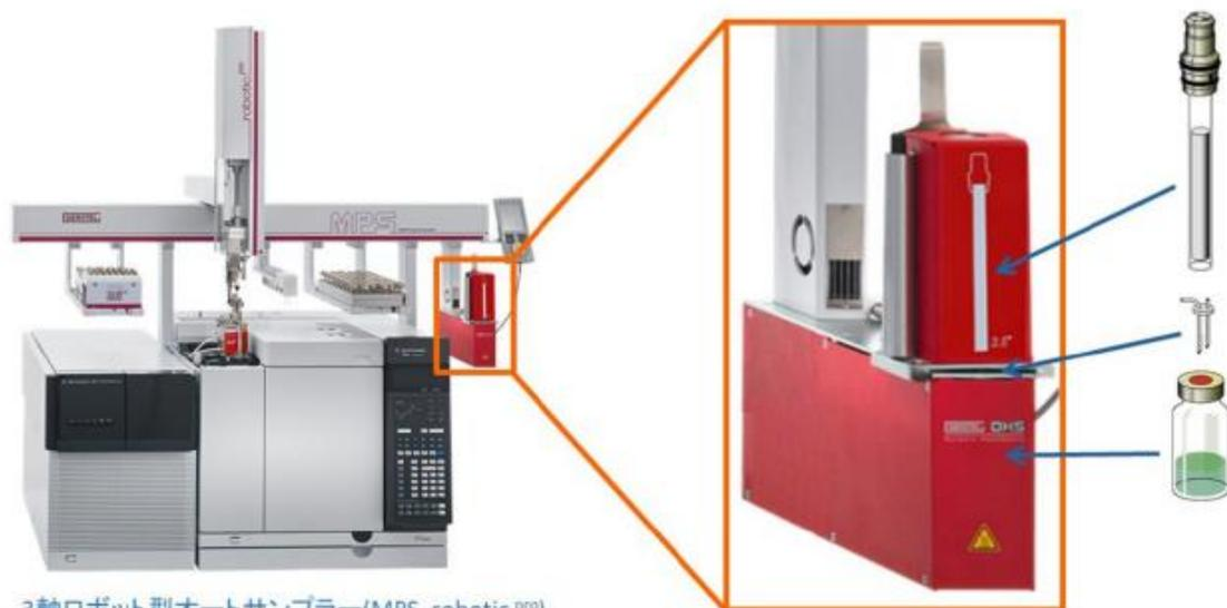
3軸ロボット型オートサンプラ(MPS robotic<sup>PRO</sup>)
